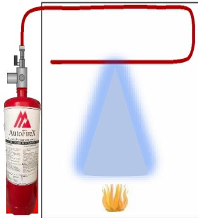
O tubo de detecção de incêndio é pressurizado com nitrogênio
